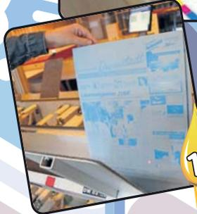
14 Aus den am Computer gestalteten Seiten werden Druckplatten hergestellt. Für jede der vier Druckfarben Blau, Rot, Gelb oder Schwarz braucht man eine Platte – jede Zeitungssseite wird also viermal bedruckt. Oh nein, Gelb ist aus – du musst neue Farbe besorgen, daher vier Felder zurück.
